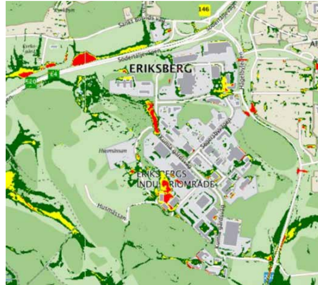
Skyfallskarta. Visar maximala vattendjup (m) i samband med ett 100-årsregn. Grön färg motsvarar områden med maximalt vattendjup på 0,1-0,3 m, gul färg motsvarar 0,3-0,5 m och röd färg motsvarar över 0,5 m, Botkyrka kommun 2017.
