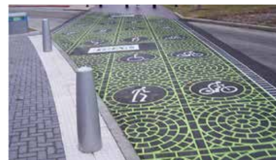
Hastighetsanpassad överfart. Överfarterna kan gestaltas med en annan markbeläggning för att hålla nere hastigheten.
